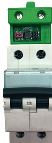
Figure 7 CcM2 instalado en magnetotermico
